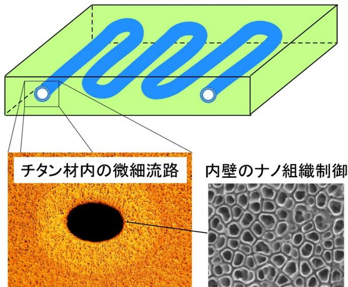
・金属粉末を焼結して金属部材を製造する粉末冶金法の進化形
