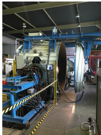
図 4a. DLR アーク風洞(L2K)外観
