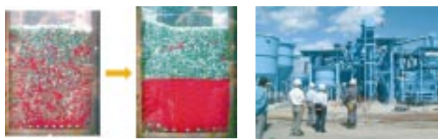
選別前 選別後 プラスチックの選別 (緑:PE、赤:PVC)
