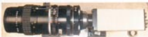
一体型撮像偏光計(偏光カメラ)
