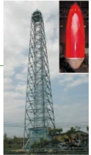
図1 微小重力実験用50m落下塔と落下カプセル。落下距離50m、微小重力場時間約3秒、搭載可能装置サイズ：直径50cm×80cm以下。
