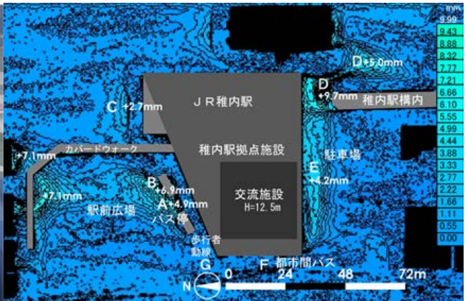
図2 稚内駅再開発計画における風雪シミュレーションの結果
