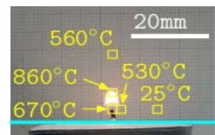
図 4 熱電対による温度測
