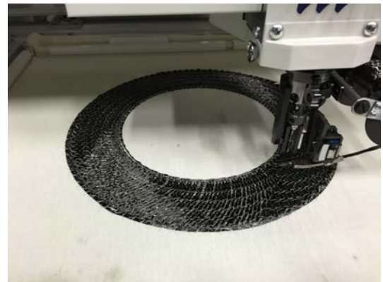
図 1 ファイバー縫付機による曲線状繊維複合材作成の様子
