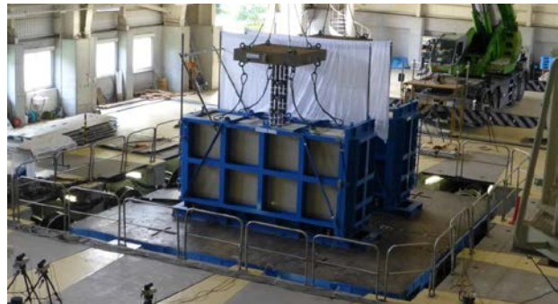
図-2 大型振動台実験の様子
