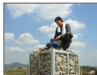
ガス抜き管からのガスサンプリングの様子
