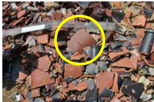
屋根瓦 \alpha : 0 cps, \beta\gamma : 280 cps
