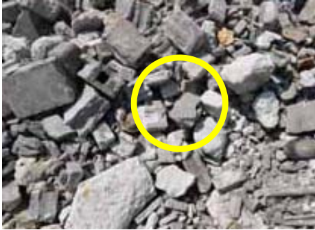
コンクリートブロック \alpha : 0.08 cps, \beta\gamma : 280 cps
