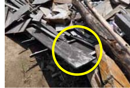
壁材 (木くず) \alpha : 0.005 cps, \beta\gamma : 160 cps
