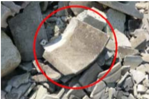
スレート瓦 \alpha : 0 cps, \beta\gamma : 530 cps
