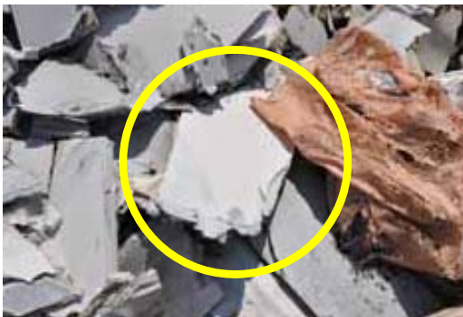
石膏ボード \alpha : 0 cps, \beta\gamma : 170 cps
