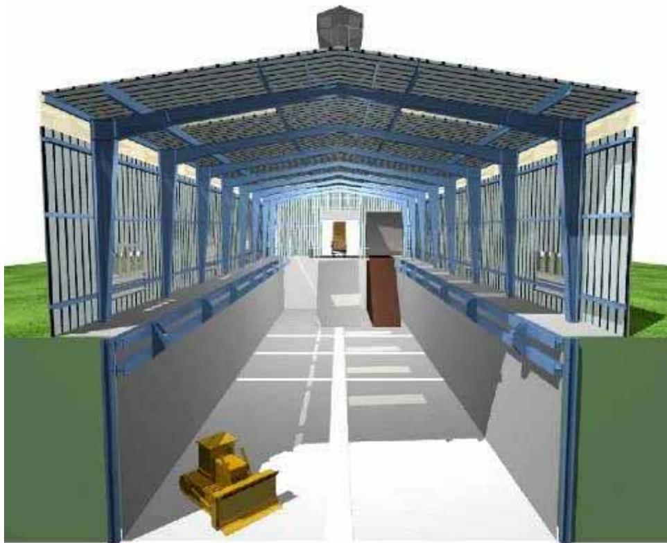
図 D-3 鋼板遮水処分場イメージ
