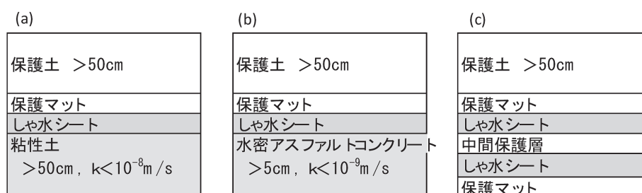
図1 基準省令による表面しゃ水工の規定(設計要領より作成)
