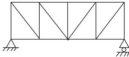
図 5.3 トラス構造 (鉄橋)
