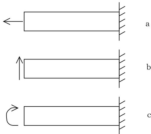
図 5.1 棒に作用する荷重
