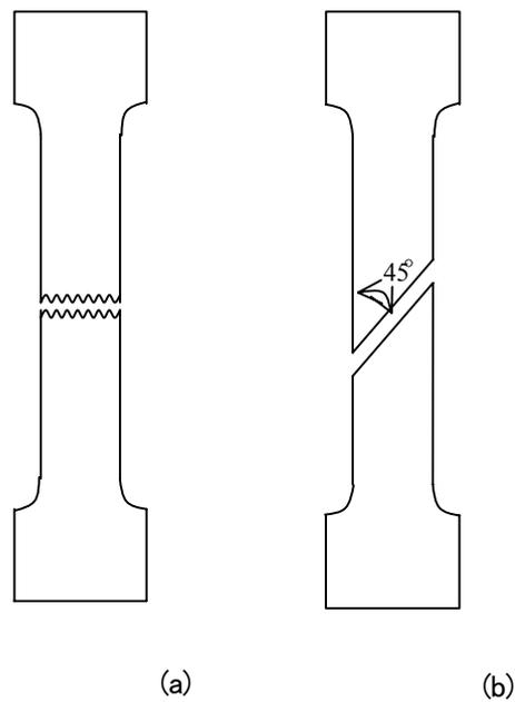
図 2. 7 供試体を一軸引張した時の破断面の形状。(a) : 岩石 (b) : 金属
