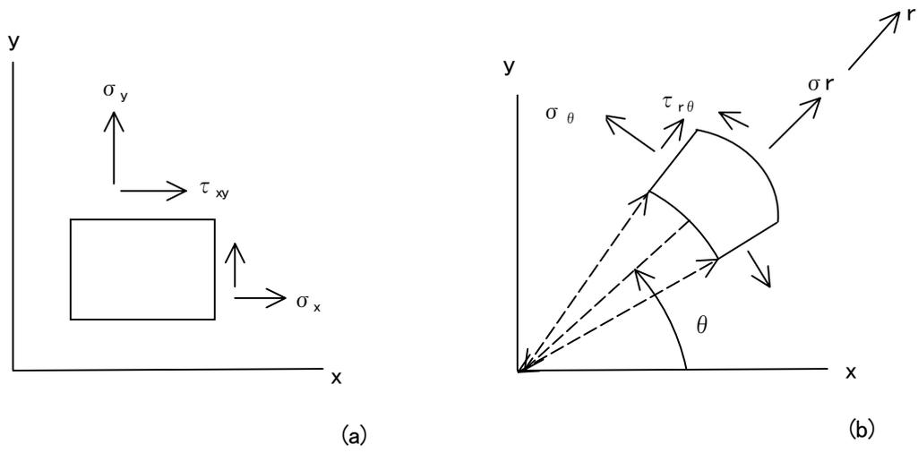
図 2.8 直交座標 (a) 極座標 (b) で表示した応力成分
