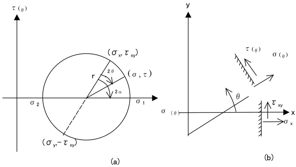
図2.10 応力モーメント円上の点 (a) と物理場における応力状態 (b) の関係
