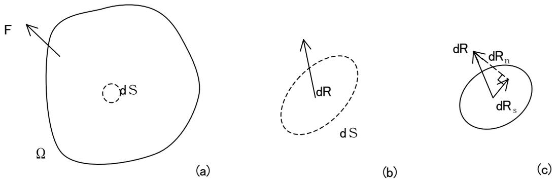
図 2.2 物体中に考えた微小な面  $dS$  に作用する内力
