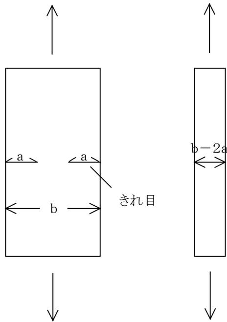
図2.11 同一の材料でできた (a) , (b) を一様な表面力  $\sigma$  で引張るとき、どちらの強度が小さいか
