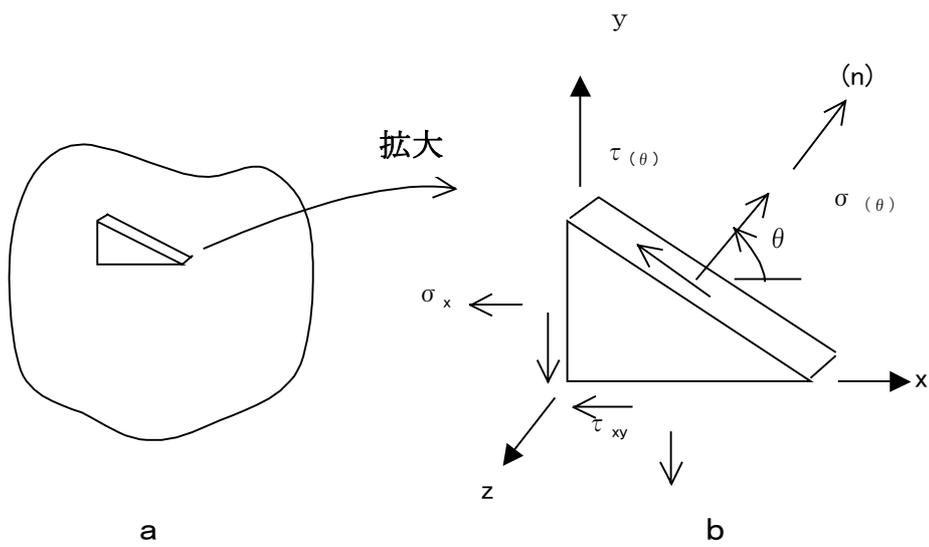
図 2. 6 物体中の微小な三角柱要素 (a) に作用する応力 (b)
