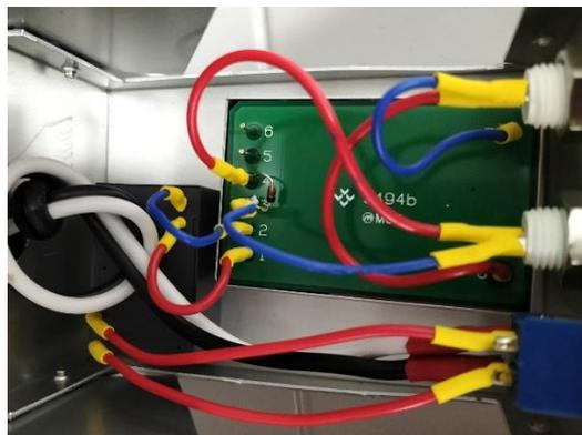
図 3.2.2：作製した PZT ドライバ
