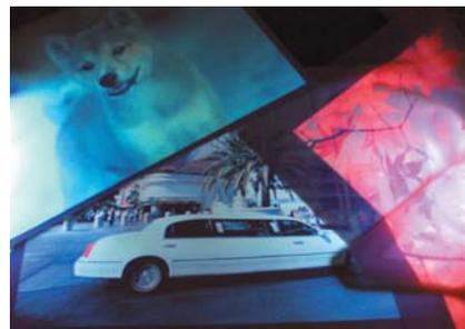
図2 希土類錯体を用いたフルカラー発光印刷
