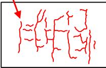
二方向ひび割れの発生 Two-directional cracks occur.
