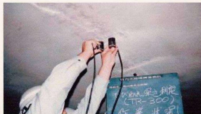
超音波法でひび割れの深さを調べている。超音波法は鉄筋の影響を受けやすいのがネックだ
