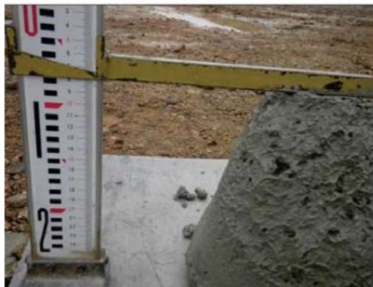
スランプ値と空気量 Slump and air content
