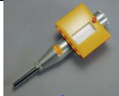
反発度試験と試験器 Rebound test and tester
