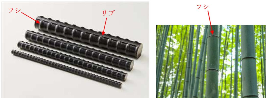
異形鉄筋は戦後に研究開発された鉄筋で、それまではフシやリブがない普通丸鋼が使われていた。当時は普通丸鋼が一般的であったが、現在ではコンクリート構造物に使う鉄筋のほぼすべてが異形鉄筋である。「異形」という言葉が一般的ではないように思えるが、単に当時の名残りである。
