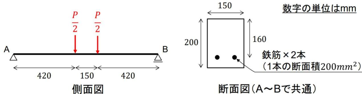
上図に示す、単純支持され、スパン中央部分に対称2点荷重を受けるRCはりの降伏時荷重 $P_y$ を求めよ。ただし、鉄筋の降伏強度 $f_y = 400\text{N/mm}^2$ 、鉄筋の弾性係数 $E_s = 200\text{kN/mm}^2$ 、鉄筋の断面積 $A_s = 3000\text{mm}^2$ 、コンクリートの弾性係数 $E_c = 25\text{kN/mm}^2$ とする。
