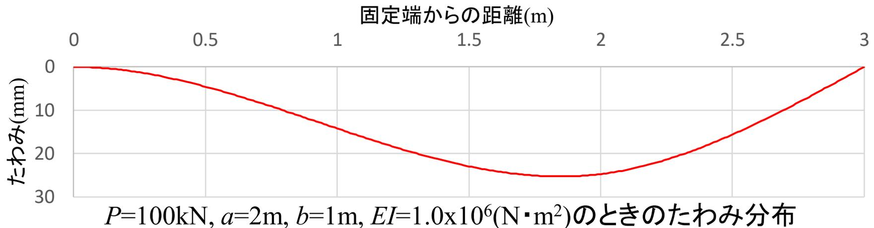
単一荷重を受ける一端固定，他端移動支点はり(解法2) beam
