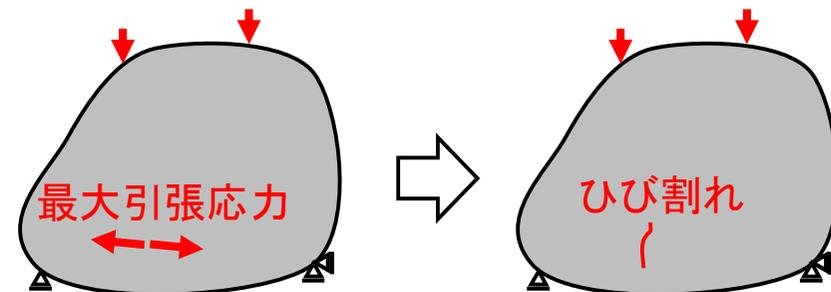
左図の位置と方向に最も大きい引張応力が作用すると、右図のようにひび割れが発生
