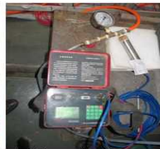
(c) 孔隙水压测试系统
