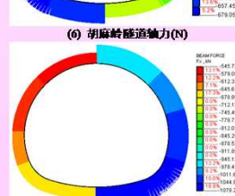
(8) 金牛山隧道断面1轴力(kN)
