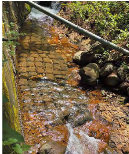
図1 北海道鹿部町の休廃止鉱山にて岩石を詰めたバッグを河川に入れて風化反応をモニタリング
