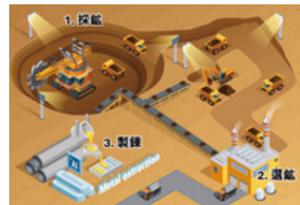
図1 鉱石から金属を生産するための採掘、選鉱、製錬のプロセス Figure 1 : Mining, mineral processing, smelting/refining processes to produce metals from ores.
