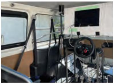
▲車内でドライビングシミュレータ実験をするための実験設備
