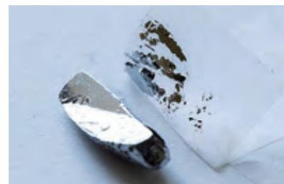
図2 Bi<sub>2</sub>Se<sub>3</sub>単結晶と、スコッチテープで剥離した薄片の写真。5枚の原子層を単位としてファンデルワールス力で結合した層状の結晶構造をもつので、テープの弱い粘着力で剥離できる。
