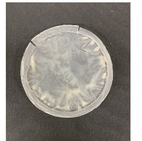
図1 組換え大腸菌から抽出したプラスチック Figure 1 : Plastic extracted from recombinant Escherichia coli
