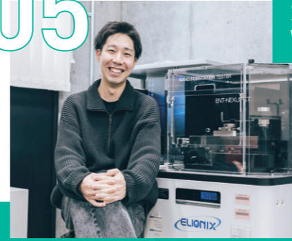
「ナノインデントは材料の極微小な領域に微小な荷重を施し、硬度や弾性率などの機械的特性をナノスケールで正確に測定する装置です」
