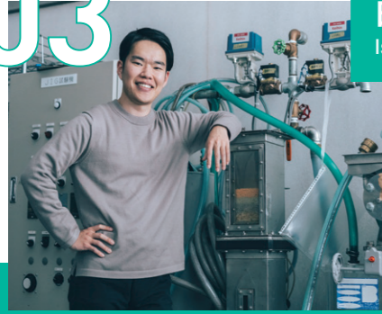
「このジグ選別機は比重が異なる成分を分けることが出来る装置です。実際に鉱山現場でも使われており、現在プラスチックの種類ごとに選別できるが実験しています」
