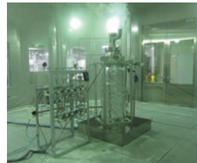
ナトリウムとコンクリートの反応 実験：中央の容器内で600℃以上に加熱されたナトリウムとコンクリートが反応しています。排煙ガスには、反応で発生した水素とナトリウムエアロゾルが含まれています。
