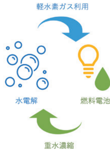
▲水素同位体の濃縮概念図(図1)
