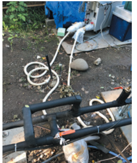
図1 地中熱ヒートポンプシステムの研究で実施した熱応答試験 Figure 1 : Thermal response test in the research of ground source heat pump system
