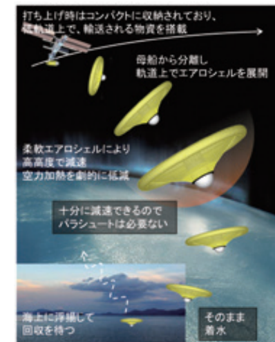
図1 展開型のやわらかい大気圏突入機による地球帰還機概念図 Figure 1 : Conceptual image of the inflatable and flexible re-entry vehicle.
