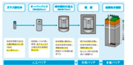
図1 地層処分の仕組み(資源エネルギー庁より引用) Figur1 : Method of geological disposal
