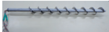
図2 実験で用いるスパイラル杭 Figure 2 : Spiral pile used in the experiment
