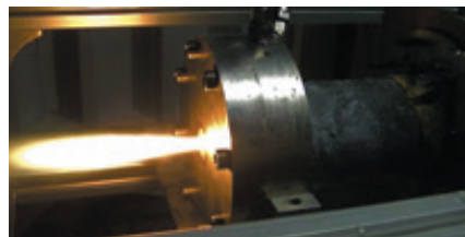
図1 燃焼実験の様子 Figure 1 : Static firing test
