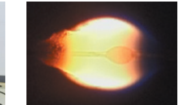
▲図2 微小重力場で電線被覆上を燃え広がる火炎
