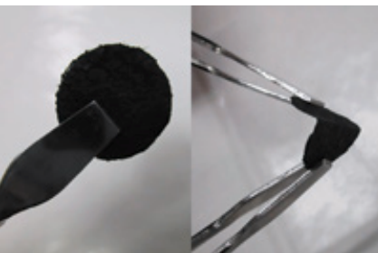
図2 長RCNTから作製したシートの写真 Figure 2 : Pictures of a flexible sheet synthesized from long CNTs.
