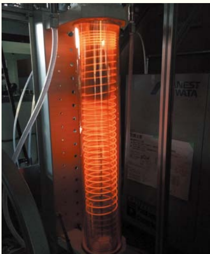
▲発電ボイラー用金属材料開発のために作製したオリジナル装置。700℃程度の高温まで加熱して実験します!
