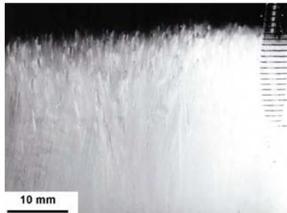
図1 水溶液(濃度10%の食塩水)の凍結層
