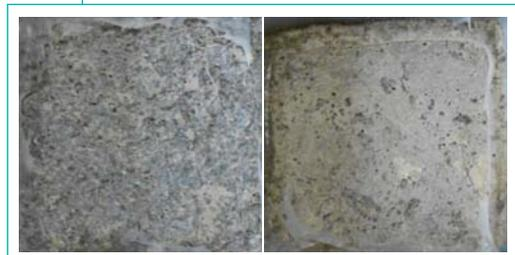
図2 環境の塩化物イオン濃度の相違によるスケール量の相違(左:NaCl濃度1%、右:5%;濃度が低いとより激しい凍害を示している)
