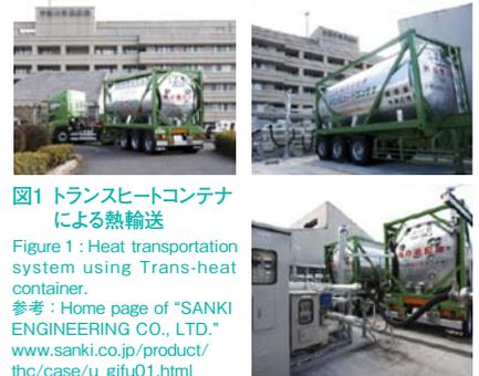
図1 トランスヒートコンテナによる熱輸送
