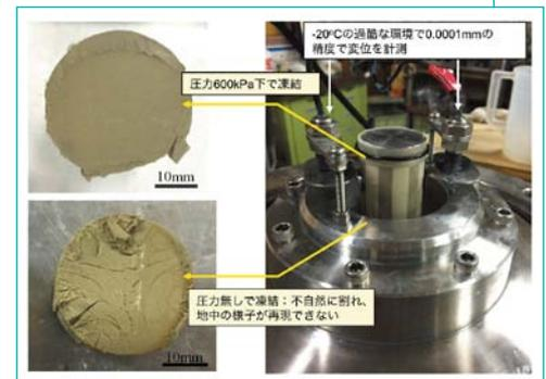
図2 実験装置内での地中人工凍結の再現 (試験時、装置は密閉される)
