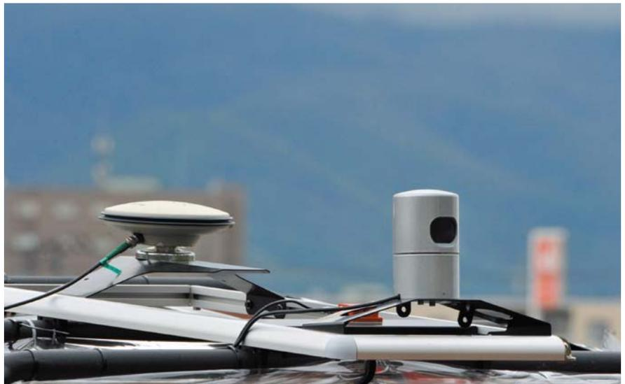
▲車両上部に搭載されたセンサー:GPSアンテナ(左)と3次元測距センサLIDAR(右)
