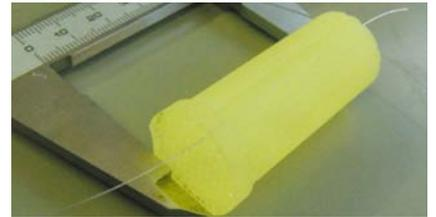
図2 高精度3Dプリンタによって成型されたロケット燃料(ポート径:0.3 mm、ポート数:86個)
