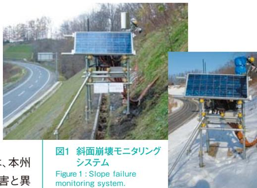
図1 斜面崩壊モニタリングシステム
