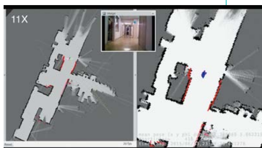
図1 2次元SLAMによる 環境マッピング Figure 1 : Mapping result using 2D-SLAM technique
