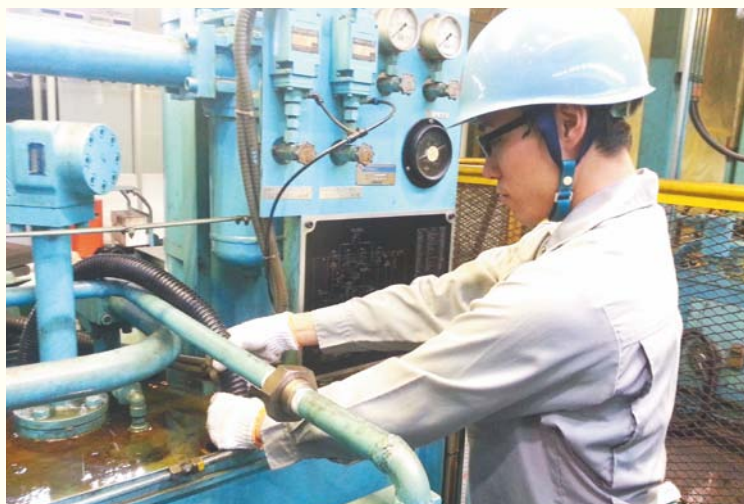
▲更油作業の様子。実際の潤滑油の使用環境・問題点を勉強できる貴重な機会です。
