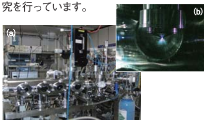
図1 (a)開発した時間分解光電子分光システム (b)真空中に吹き出した希ガスにレーザー光を集光し高次高調波を発生する
