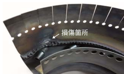
図1 小型ガスタービンの燃焼器の損傷事例 Figure 1 : Damaged micro-gas turbine combustor.
