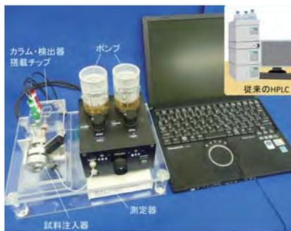
図1 我々のグループが開発した超小型高速液体クロマトグラフ (HPLC)。サイズの比較のため従来のHPLCのイメージを載せている。
