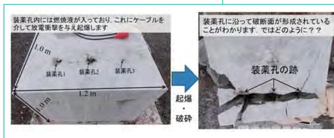
図1 放電衝撃破碎工法を用いたコンクリート破碎実験の様子
