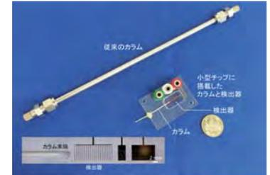
図2 超小型HPLC用にチップに搭載されたカラムと検出器(顕微鏡写真)と従来のカラム。
