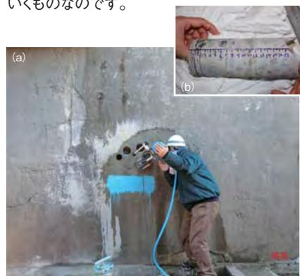
図2 (a)コンクリートサンプルの採取
