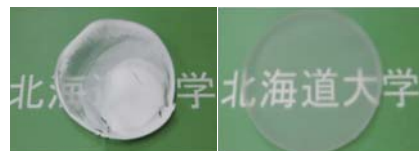
図2 天然で合成される3-ヒドロキシ酪酸をモノマーユニットとするポリエステルフィルム（左）と人工的に改変した合成系で合成された乳酸を含むポリエステルの透明フィルム（右）。乳酸のフィルム（右）では、背景の文字をはっきりと読むことができる。
