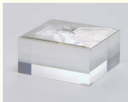
▲NTTが世界で初めて大型化に成功した光学品質 KTN単結晶 (40mm角×20mm厚)
