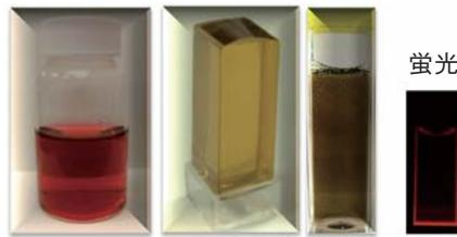
図1 さまざまな金属ナノ粒子の色。ナノ粒子はその材質、大きさによって異なった色を見せる。右のものは蛍光発光しているナノ粒子。
