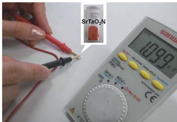
図3 新規酸窒化物誘電体  $\text{SrTaO}_2\text{N}$  セラミックス。静電容量から見積もられる誘電率  $\epsilon_r$  は約6000と、鉛を含む既存材料に匹敵する。
