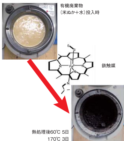
図1 有機鉄触媒によるモデル有機廃棄物(米糠)から堆肥様物質の生成
