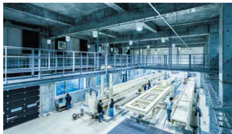
11 地球流体実験室 全長20mの大きな水槽が並び、海洋の波や河川の流れをリアルに再現。海洋災害や洪水のメカニズム解明、防災施設に関する先端研究が行われています。
