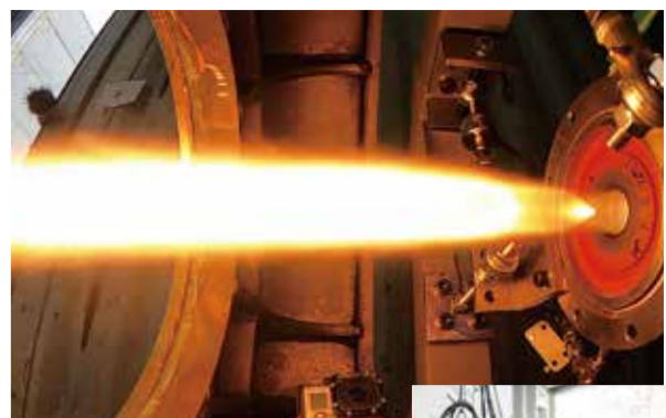
17 防弾実験室 ロケットの燃焼実験を行う研究施設。エンジンの仕組みや性能を検証し、宇宙開発につながる研究が進められています。
