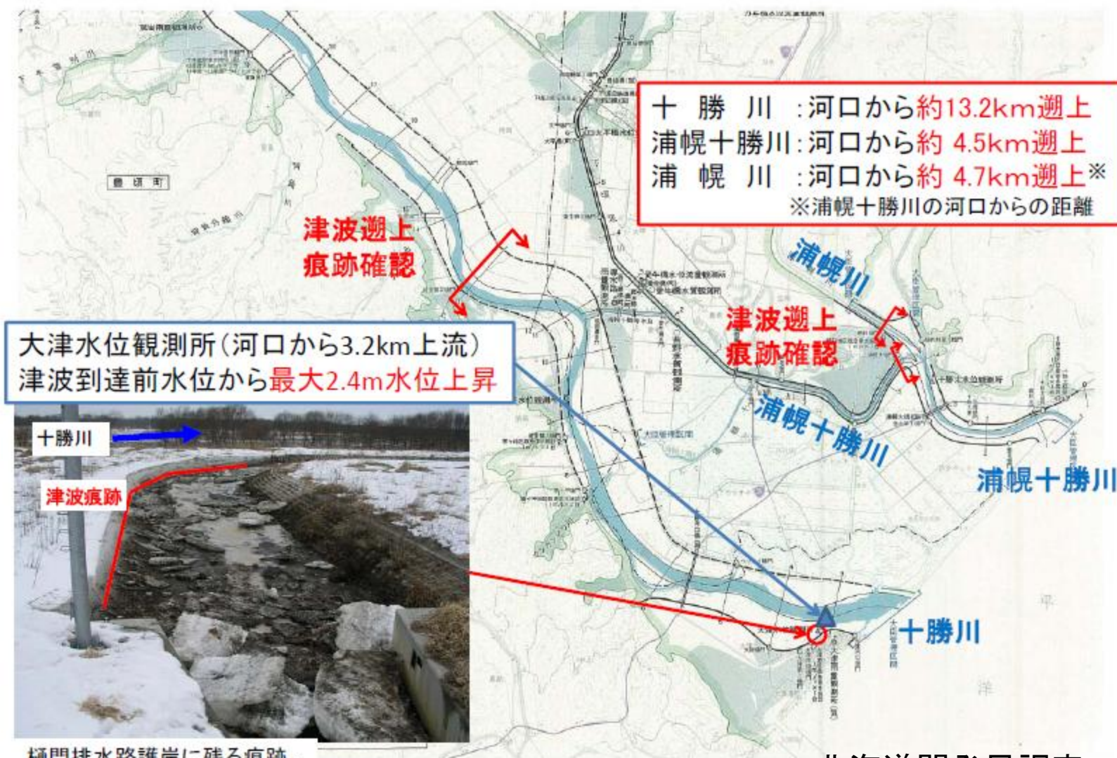
樋門排水路護岸に残る痕跡。
