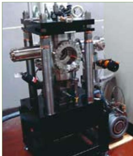
図2 超高真空疲労試験機
