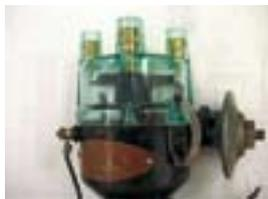
エンジン部品の多くはすでに調達不可能であった。同一規格の代替品とダットの部品と組み合わせて作成されたディストリビュータ。
