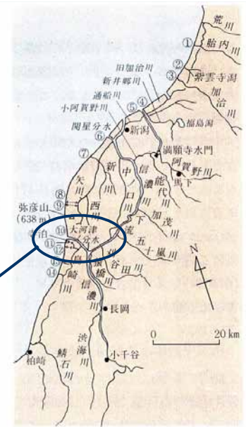
図 4.6 新潟平野の河川と放水路。わずか 100 km 程度の間に 14 本もの人工放水路がある。低湿地である新潟平野にとって排水条件の改良がいかに重要であるかを物語る。(6・26 新潟水害調査研究組織, 1979)
